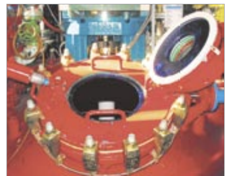
Abb. 3: Offene DN 300 Einfüllöffnung auf Mannlochdeckel mit Kurbelverschluss und Perel® Handloch-Dichtung
