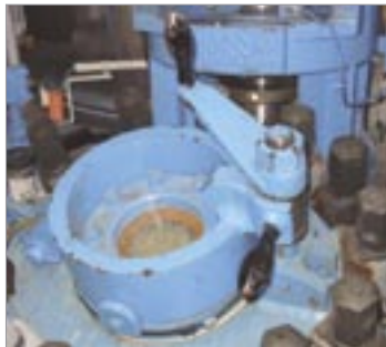
Abb. 1: DN 200 Handloch mit Kurbelverschluss und Perel® Handloch-Dichtung auf Stahlemail Rührwerkskessel
